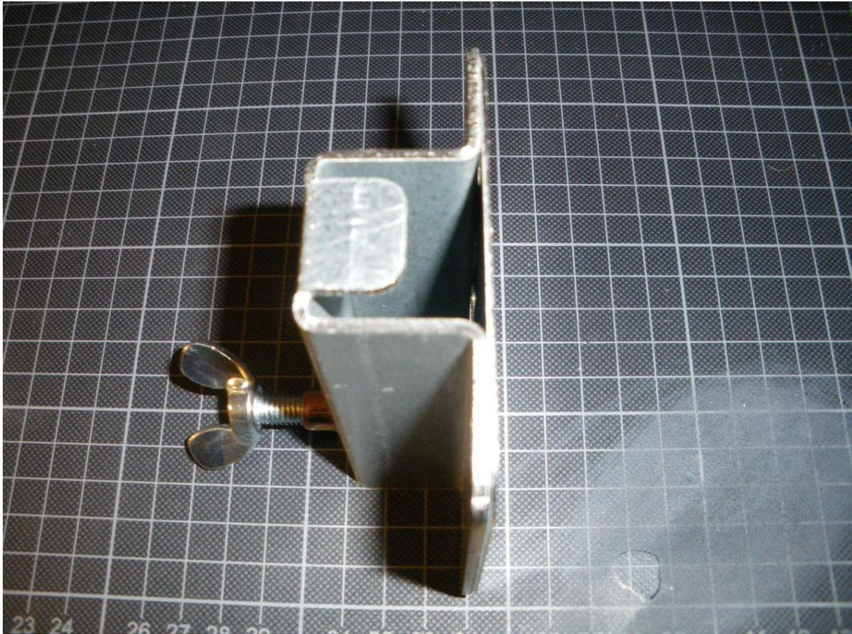
Um eine optimale Führung für das Vierkantrrohr zu erreichen, besteht ein Halter immer aus dem gekanteten Vorderteil und der Rückenplatte. Diese wird ebenfalls auf der Innenseite verschraubt und stellt ein leichtes Einschieben sicher. Auch wird ein Verkannten im Holz wie es bei schräg eingeschobenen evtl. scharfkantigen Vierkantröhren vorkommen kann zuverlässig verhindert.
