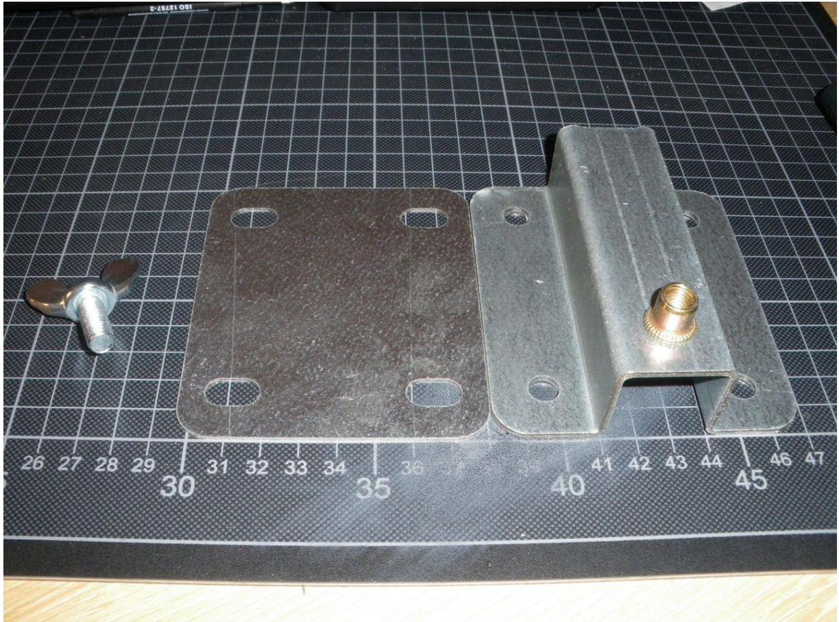
Die Halterungen verfügen über einen Anschlag. Auf diese Weise wird verhindert, dass evtl. Styrodurplatten durchstoßen werden.
